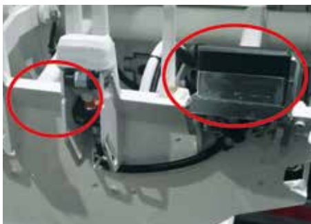
Figura 38. Antenne LF fissate su attacco a pettine
