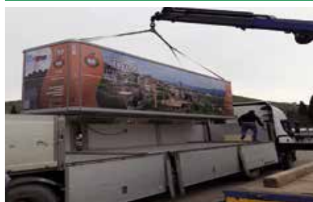
Figura 64. Sistema per la movimentazione con gru
