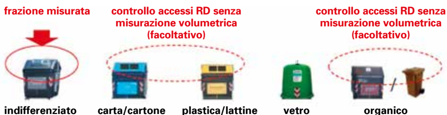
Figura 22. Modello di raccolta stradale con tariffa puntuale diffuso in Emilia Romagna (gestore Hera spa). Configurazione dell’isola ecologica di base (IEB) con cassonetto del RUR che utilizza il limitatore volumetrico
