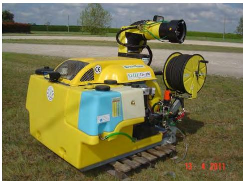
L'atomizzatore per la disinfestazione e disinfezione di aree marca SPRAY TEAM mod. ELITE.
