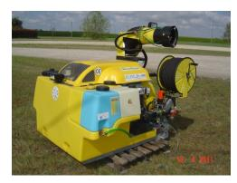
L'atomizzatore per la disinfestrazione e disinfezione di aree marca SPRAY TEAM mod. ELITE.
